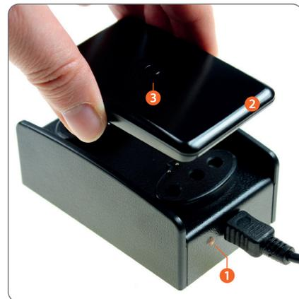
Collegare il caricabatterie all'alimentazione utilizzando l'alimentatore a spina. Il caricabatterie è pronto per l'uso se il suo LED è arancione ❶. Utilizzare il caricabatterie esclusivamente con l'alimentatore in dotazione!
