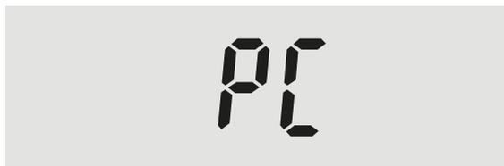
Durante la trasmissione dati tra registratore e PC, sul display viene visualizzato "PC" (il diodo luminoso dell'interfaccia a infrarossi custom com IR lampeggia).
