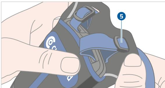
Fissare la cinghia a tracolla al registratore. Se si utilizza una custodia di stoffa, far passare i passanti della cinghia a tracolla attraverso i fori superiori della custodia. I regolatori della lunghezza dei passanti della cinghia vengono guidati attraverso i fori **5**. Mettere i passanti intorno ai supporti della cinghia della batteria e stringerli saldamente.
