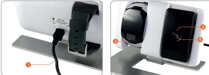
Schließen Sie die custo docking station mit dem Micro USB-Kabel ① am laufenden PC an. Verwenden Sie ausschließlich das mitgelieferte Micro USB-Kabel. Wahlweise kann die custo docking station mit dem Steckernetzteil an der Stromversorgung angeschlossen werden.
